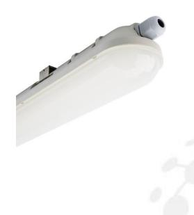
Material: Aluminio-PC 18-36-48W Potencia: Ta Ambiente Trabajo: -20°C ~ +40°C Fuente Lumínica: Epistar-SMD2835 Protección IP: IP65 Clase Energética: **A**+ Rendimiento Led: 85-90 lm/w Tipo de Lente: Opal Ángulo de Apertura: 1200 Certificados: CE & RoHS Frecuencia: 50-60 Hz Vida Útil: 30.000 Horas Protección IK: IK04 Índice Rep. Cromática (CRI): 80 Clase Aislamiento Eléctrico: Ι
