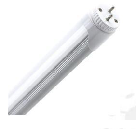
Potencia: 9-14-18-24 W Tensión: 220-240 AC Rendimiento Led: 120 lm/w Factor de potencia: 0.93 Ta Ambiente Trabajo: -20°C ~ 45°C Fuente lumínica: Epistar-SMD 2835 Material: Aluminio/PC Regulable: No Tipo de Lente: Opal Casquillo: T8 Clase Energética: Α+ Certificados: CE & RoHS
